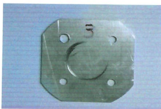
Figura 7.5 – Corpo-de-prova com Faxial = 142,42N
