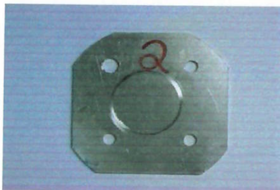
Figura 7.4 – Corpo-de-prova com Faxial = 126,38N
