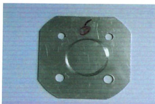
Figura 7.8 – Corpo-de-prova com Faxial = 190,30N
